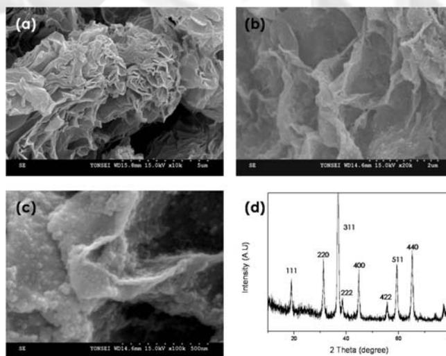
**Fig. 1** SEM images of (a) GNS, (b)  $\text{Co}_3\text{O}_4/\text{GNS}$  nanocomposite (c) high magnification and (d) XRD patterns of  $\text{Co}_3\text{O}_4/\text{GNS}$  nanocomposite.
