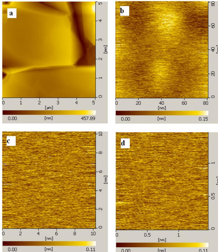
**Fig 3-9.** AFM scanning images of expanded graphite: (a 600nm×600nm ; b 80nm×80nm ; c 10nm×10nm ; d 1.5nm×1.5nm.)
