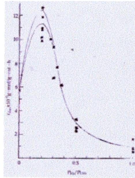
Fig 4. Deposition rate vs.  $P_{CH_4}/P_{H_2}$
